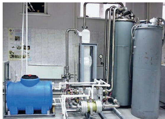
Рис. 6. Стенд для испытаний систем криогенного охлаждения
