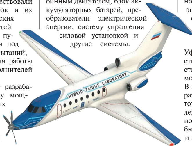
Модель летательного аппарата на базе Як-40 для проведения испытаний демонстратора гибридной силовой установки
