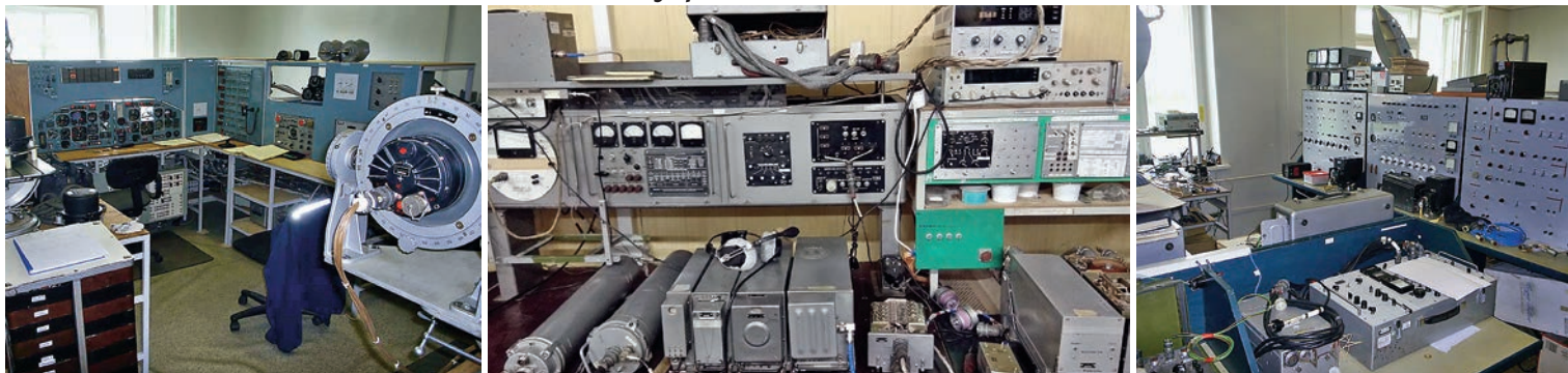
Рабочие места проверки навигационного комплекса Ан-74 (72), КВ радиостанций «Ядро» и «Микрон», систем управления Ан-74
